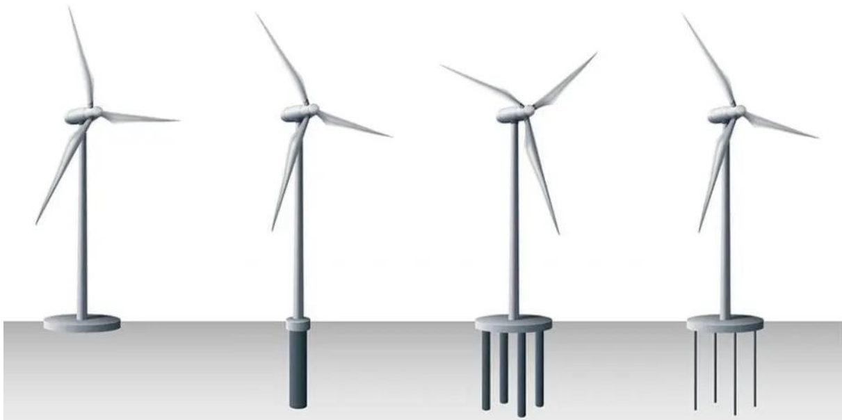
Joonis 4. Tuulikute vundamentide tüübid 8 .
